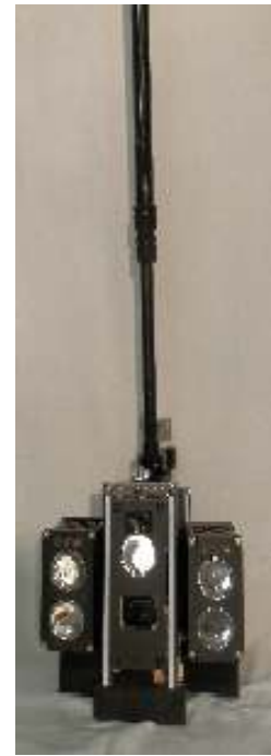
カメラ支柱と昇降装置
