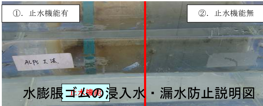
①. 水膨張ゴム装着 止水機能有
