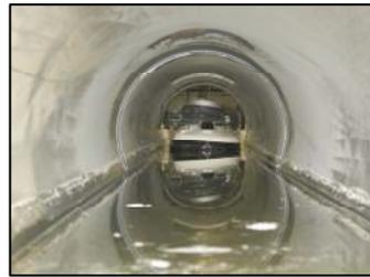
☆水空浮上船TVカメラ調査システム(実証中)、
