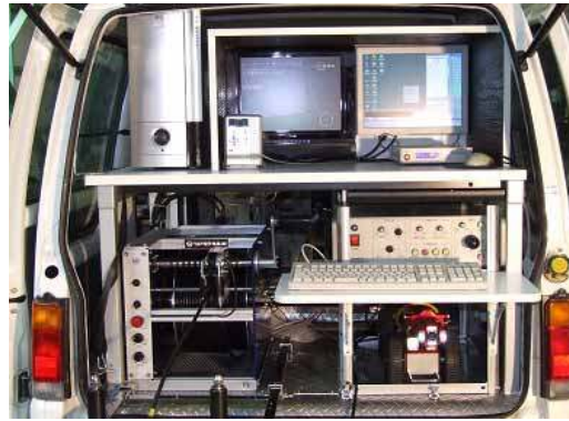
全TVカメラ調査 制御・情報管理システム搭載車輛
